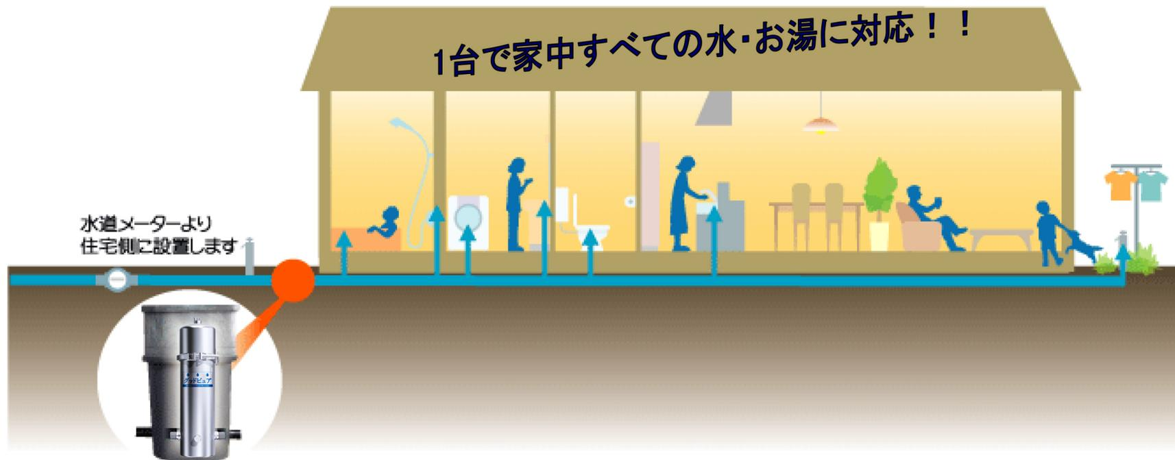
セントラル浄水とは一般家庭の水道管の大元(水道メーター後)に浄水器を取り付け**家中すべての蛇口**から浄水されたキレイで美味しい水が出てくるシステムのことです。
